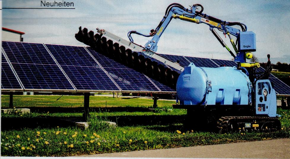
◁ Die 3 m lange Reinigungsbürste des „Eagle“ ist zusammen mit einem Wassertank auf einem Raupenfahrwerk montiert.
